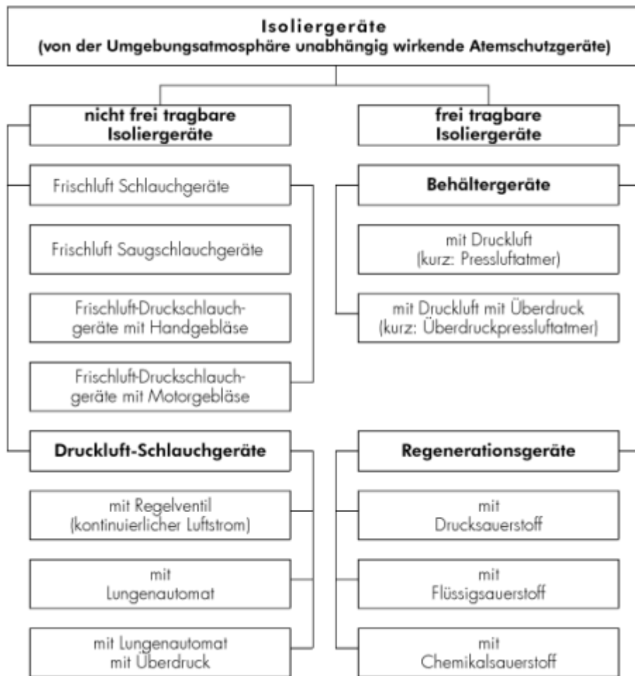
Bild 20: Einteilung der Isoliergeräte
