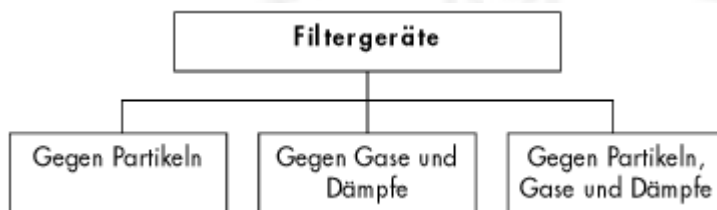
Bild 4: Einteilung der Filtergeräte nach Schadstoffart
